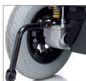
Antivuelco de serie, amortiguación trasera. Anti-tipping wheels and back suspension.
