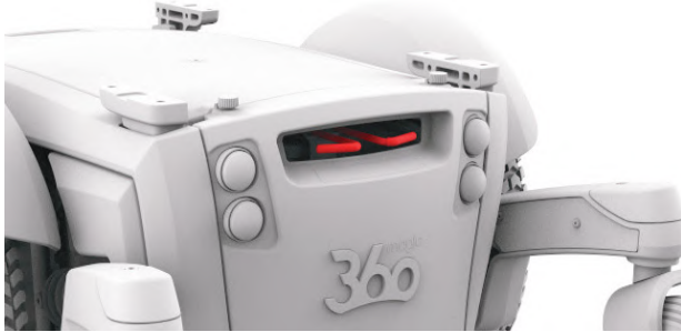
Figura 4.4a Palancas de freno de Magic 360 activadas
