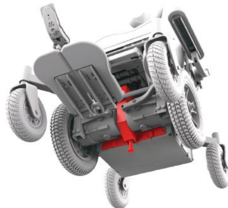
Figura 5.7d Clavija de acoplamiento de Frontier - extendida
