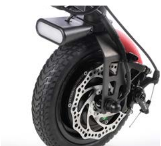
Luz delantera LED, guardabarros en rojo y freno de disco (mostrada en rueda maciza de 8,5")
