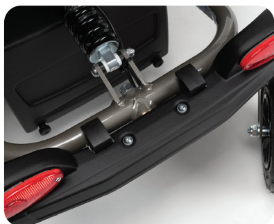
Eje giratorio para permitir un contacto constante con el suelo
