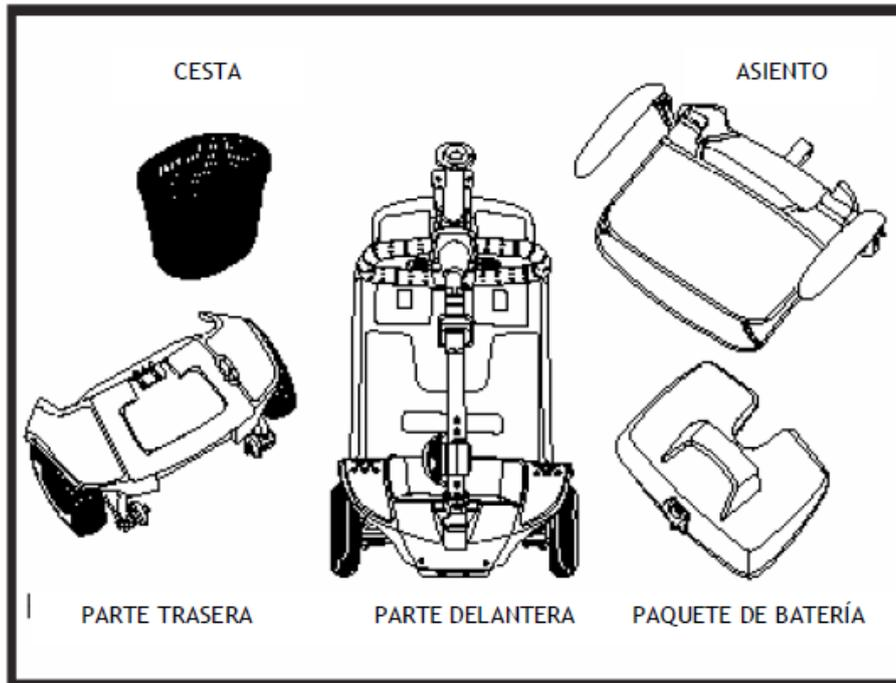
Figura 13. Desmontaje y montaje
