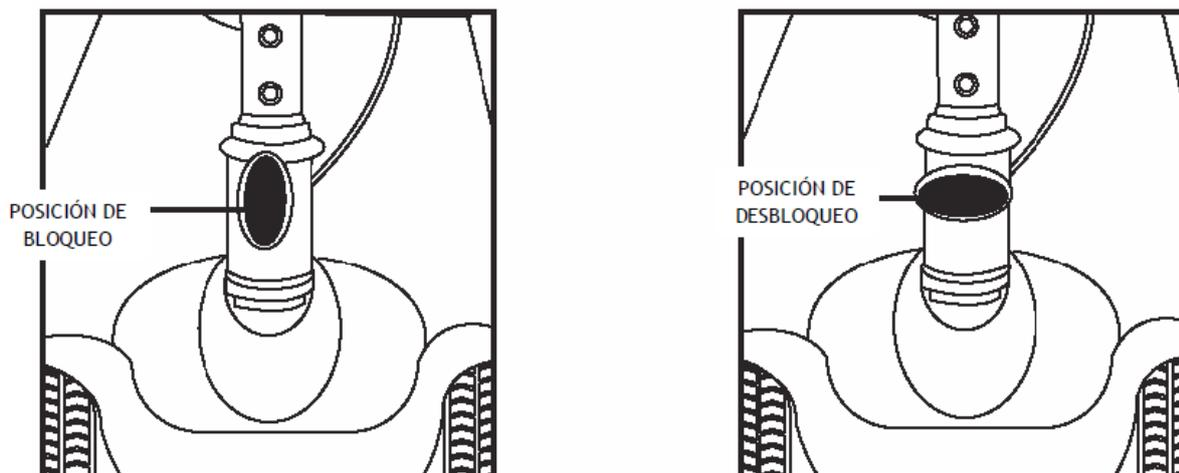
Figuras 14 y 15. Botón de bloqueo de manillar bloqueado (izquierda) y desbloqueado (derecha)
