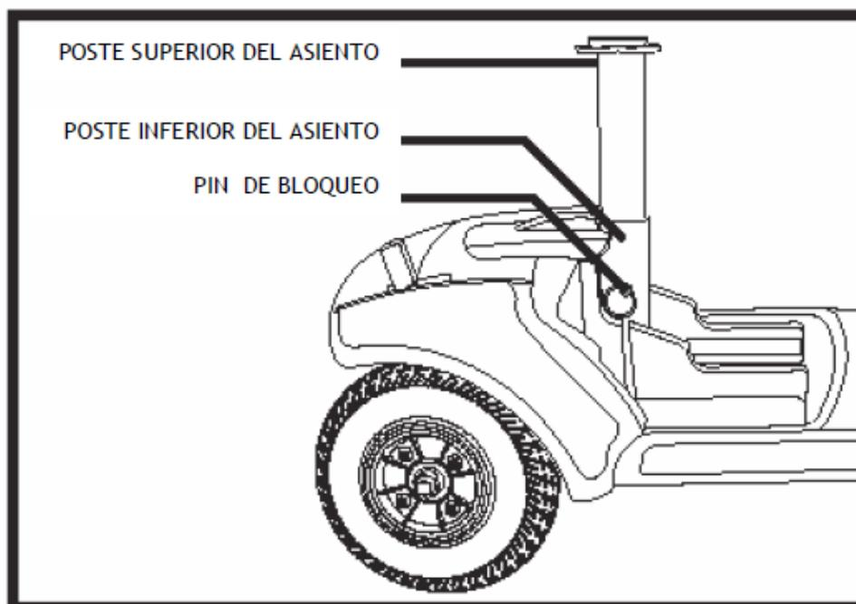
Figura 11. Ajuste de la altura del asiento
