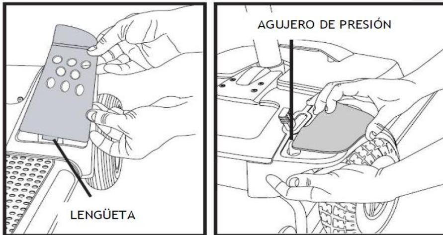
Figuras 6 y 7. Panel del guardabarros delantero y panel del guardabarros trasero
