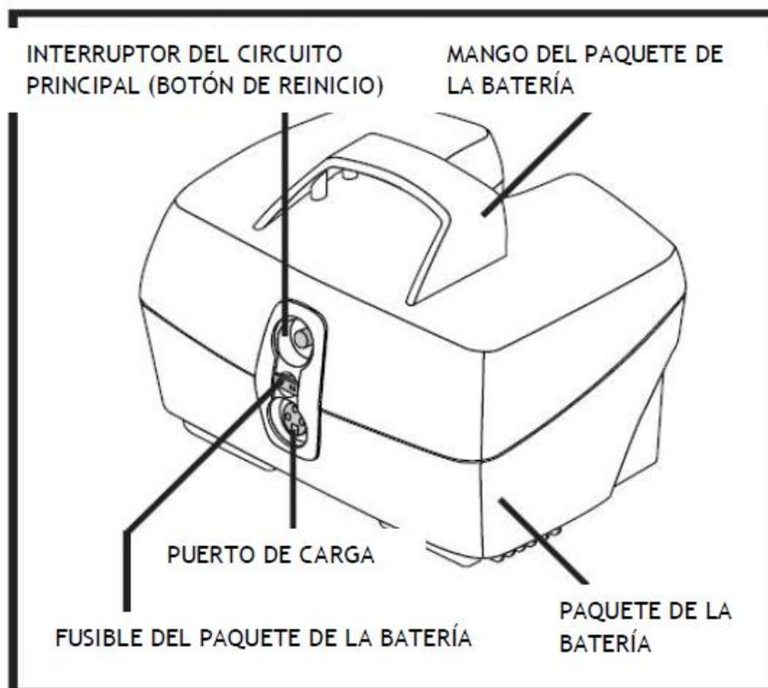
Figura 3. Paquete de la batería
