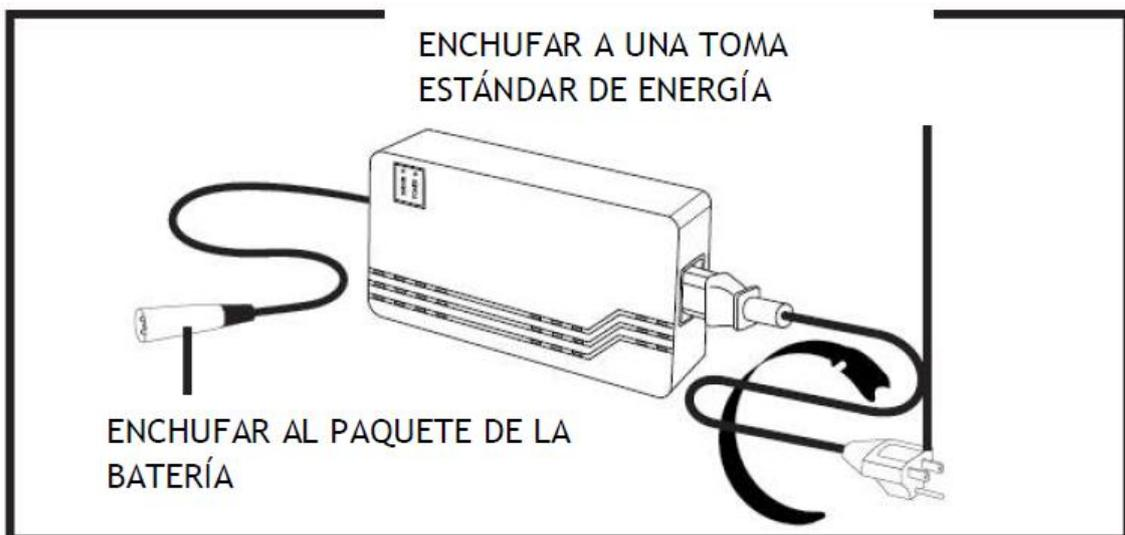
Figura 5. Cargador externo de la batería
