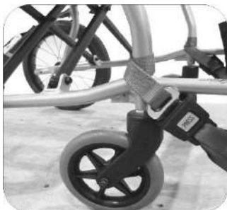
Fijando anclaje frontal
