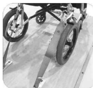
Fijando anclaje trasero
