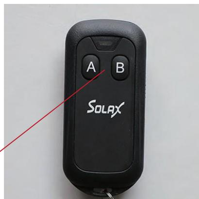
Colocar el selector en la posición A, pulsar la tecla B del control remoto con el pulgar y la silla comenzará a plegarse. Levantar el pulgar cuando la silla esté completamente plegada.
